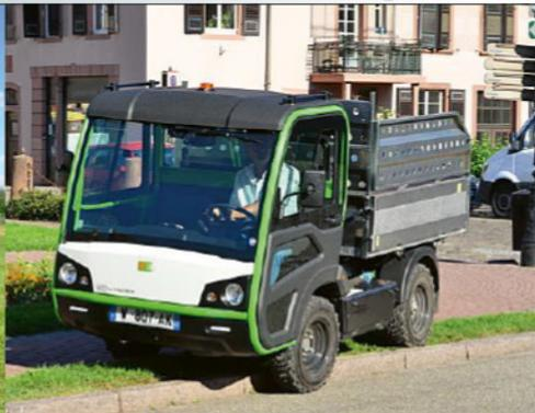
ET Lander: das neue Elektro Multifunktionsfahrzeug von ETESIA mit hydraulisch kippbarer Ladebrücke (auf 3 Seiten)
